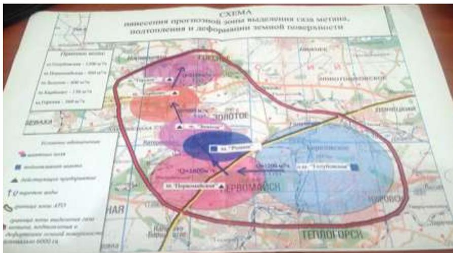
Рисунок 4 – Схема нанесения прогнозных зон выделения газа метана, подтопления и деформации земной поверхности
